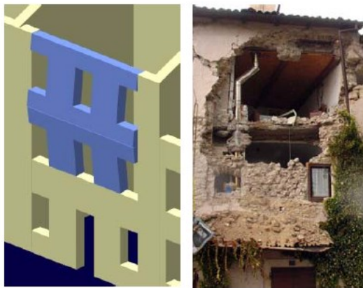
Fig. 24 - Flessione verticale di parete a due piani
