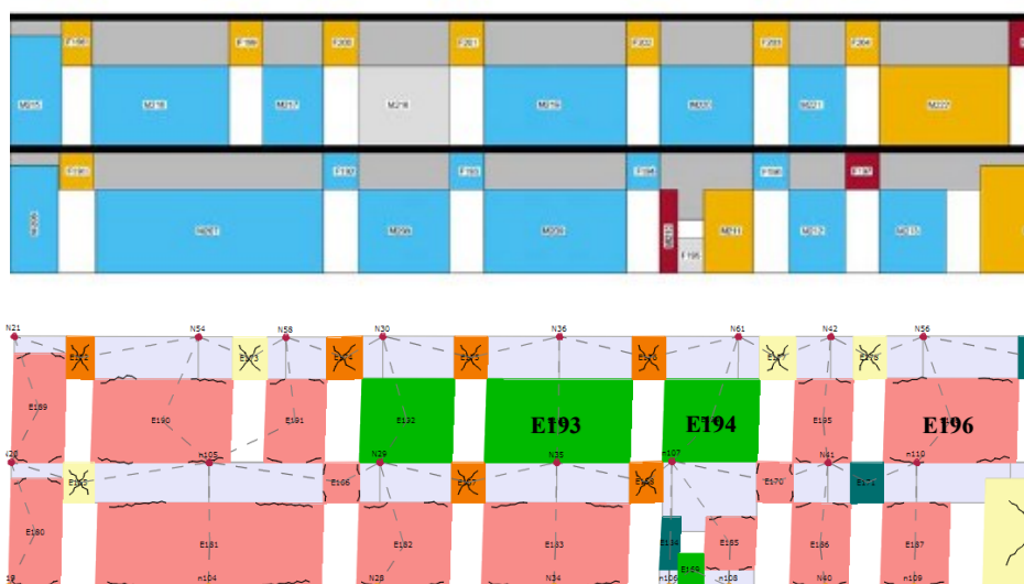
Fig. 120 - Confronto modalità di rottura maschi E193, E194 ed E196 parete P7
