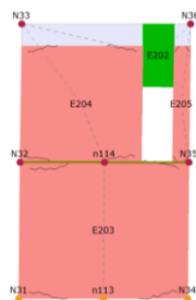
Fig. 93 - Danneggiamento della parete P9
