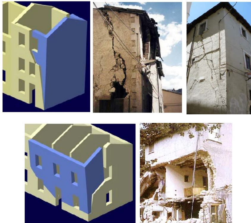
Fig. 44 - Meccanismi di ribaltamento composto
