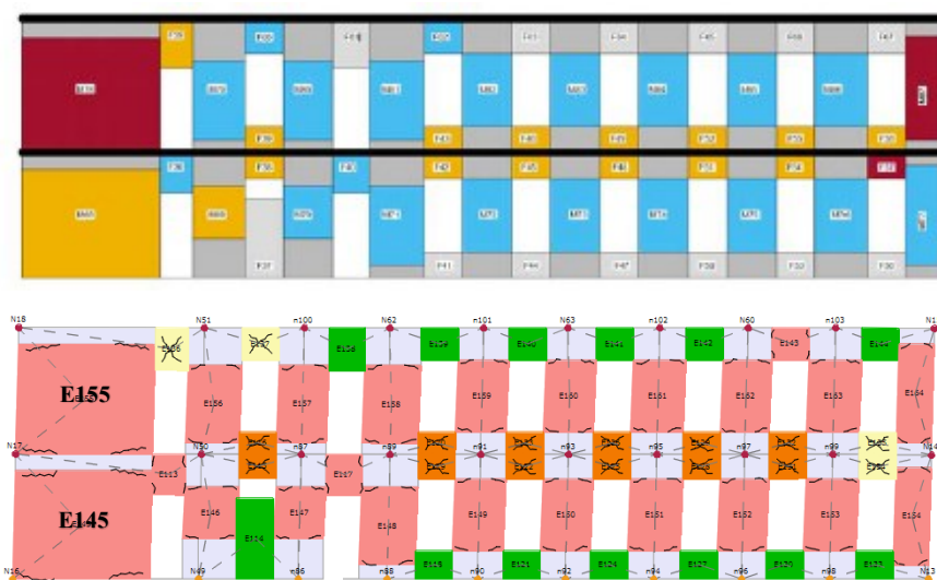
Fig. 117 - Confronto modalità di rottura maschi E155 ed E 145 parete P6
